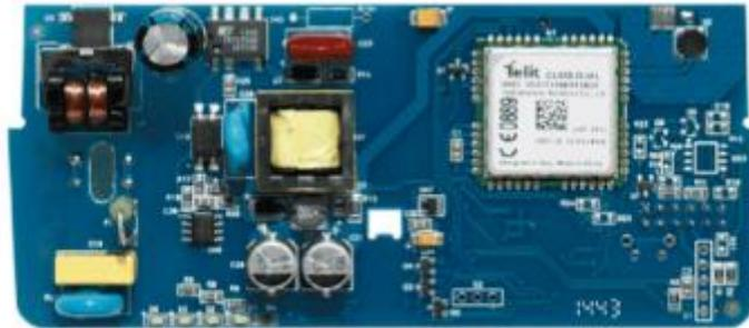
Серия многоканальных устройств для сбора и беспроводной передачи данных по сети NB-IoT. Стандарт связи Cat NB2 обеспечивает более высокую скорость передачи по сравнению с первым поколением NB-IoT – до 150Кбит/сек.
