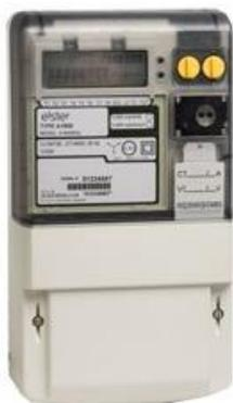
Многофункциональный микропроцессорный счетчик АЛЬФА А1800 трансформаторного включения предназначен для учета активной и реактивной энергии и мощности в трехфазных сетях переменного тока в режиме многотарифности, хранения измеренных данных в своей памяти, а также передачи их по цифровым и импульсным каналам связи на диспетчерский пункт по контролю, учету и распределению электроэнергии.
