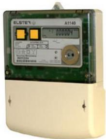
В счётчике АЛЬФА А1140RAL-BW-4П есть встроенные часы для ведения тарифного учёта, имеются импульсные выходы и один из цифровых интерфейсов - RS232, RS485. Специализированное программное обеспечение позволяет программировать счетчик, производить чтение данных и параметров сети преобразователем UNICOM через оптический порт счетчика
