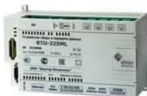
УСПД RTU-325ML применяют в интеллектуальных системах учета электроэнергии (Smart metering) и в системах управления энергопотреблением для промежуточного сбора данных со счетчиков электроэнергии по технологии PLC Prime и передачи данных в систему сбора.
