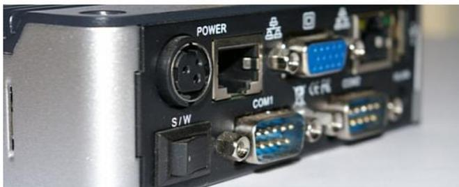
УСПД RTU-325S (Small) имеет самый маленький размер и входит в семейство УСПД RTU-325, которое включает в себя RTU-325, RTU-325L, RTU-325T. Все УСПД имеют одинаковое прикладное ПО и одинаковую операционную систему QNX. Отличия в семействе УСПД RTU-325 определяются разными конструктивными особенностями, производительностью процессоров, объемом оперативной памяти, типом и количеством интерфейсов.
